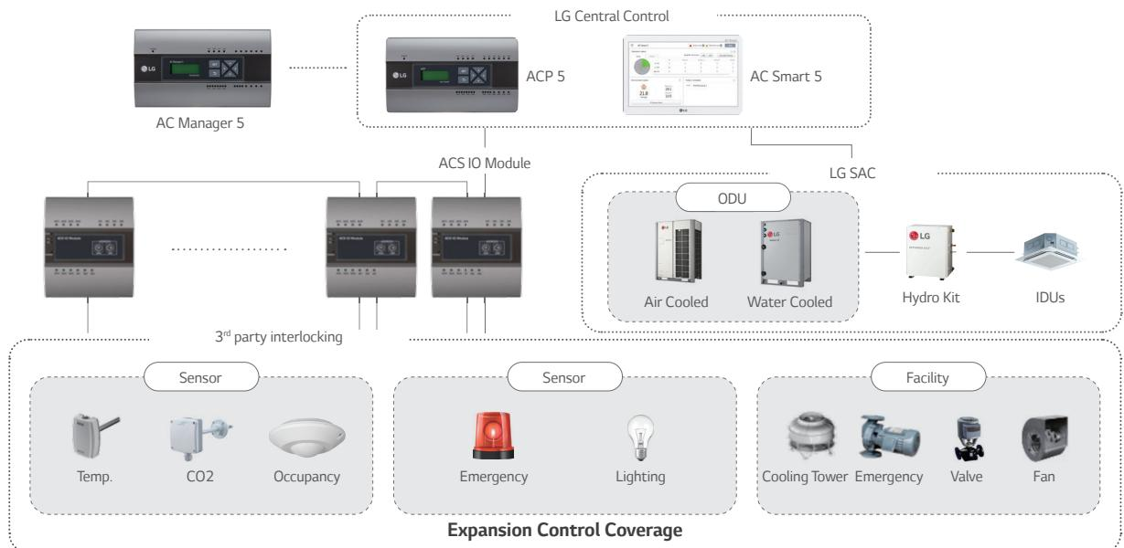
※ DI : Digital Input, DO : Digital Output, UI : Universal Input, AO : Analog Output
