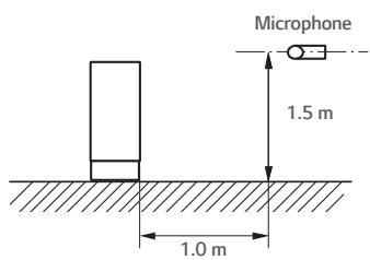
※ Measuring place : Anechoic chamber
