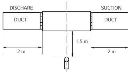
※ Measuring place : Anechoic chamber
